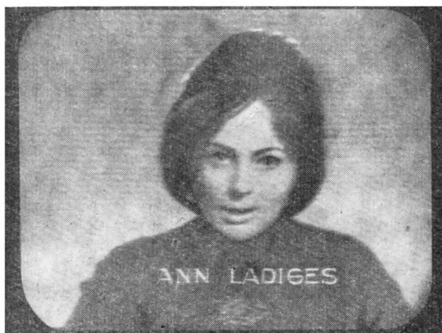
Рис. 72. Нормальное изображение, наблюдаемое при приеме за счет отражения УКВ от слоя E_s (телецентр ФРГ на частоте 62,25 МГц).
